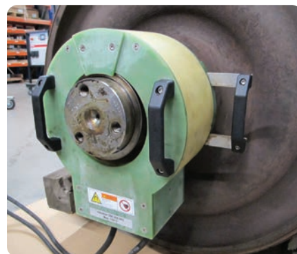
Verwarming van lagerringen voor demontage
