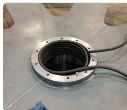
Verwarming van een boring voor montage van lager of as
