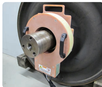
Verwarming van labyrintingen voor demontage
