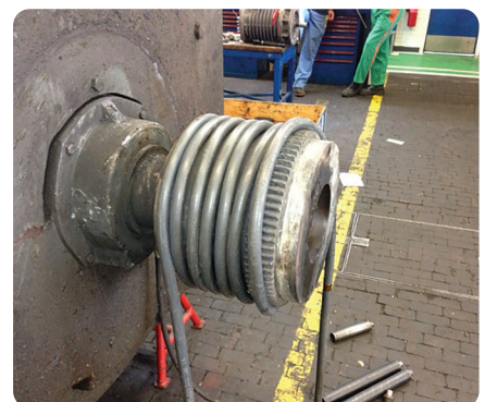
Erwärmung einer Kupplung zur Demontage
