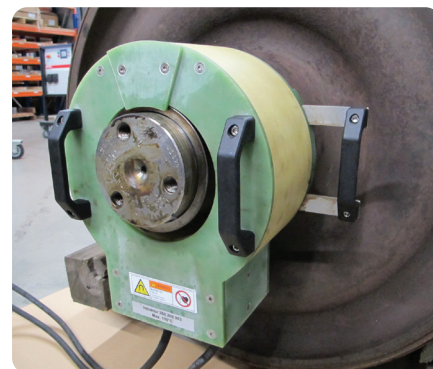
Erwärmung eines Lagerrings zur Demontage
