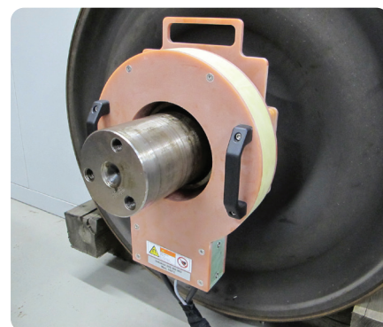
Erwärmung eines Labyrinthrings zur Demontage
