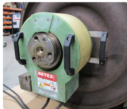
Calentamiento de anillos de rodamientos para desmontaje
