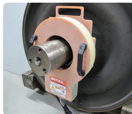
Calentamiento de anillos laberínticos para desmontaje
