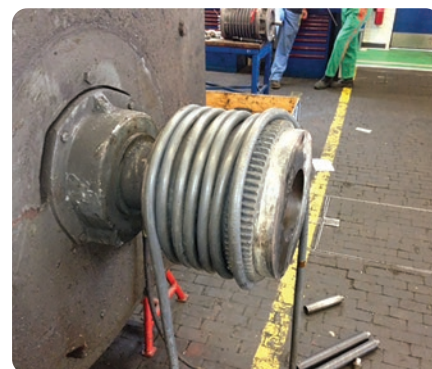
Calentamiento de un acoplamiento para desmontaje
