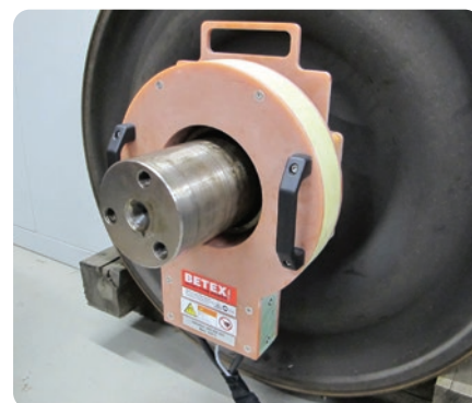
Chauffe de joints labyrinthes pour démontage
