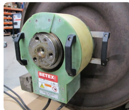
Chauffe de bagues de roulement pour démontage
