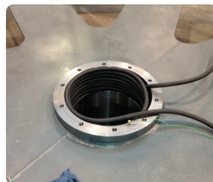
Chauffe d'un alésage pour montage d'un roulement ou d'un arbre
