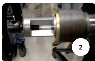
Démontage étape par étape de jeux de roulements TBU / SP / TAROL
