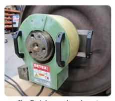
Chauffe de bagues de roulement pour démontage
