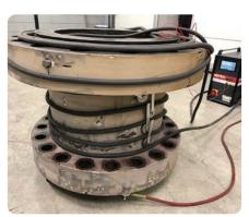
**BETEX MF Quick-Heater 3.0, 22 kW** Préchauffage pour la préparation du revêtement laser.
