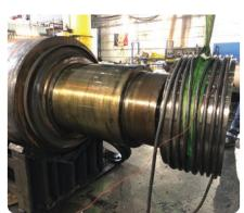
BETEX MF Quick-Heater 3.0, 22 kW Démontage dans une aciérie à l'aide d'un inducteur flexible enroulé autour d'une bague de roulement.
