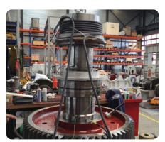
**BETEX MF Quick-Heater 3.0, 44 kW** Démontage d'un accouplement dans un atelier de réparation d'engrenages.
