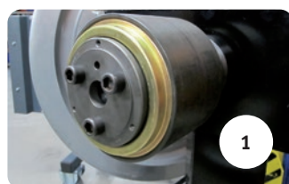
Démontage étape par étape de jeux de roulements TBU / SP / TAROL
