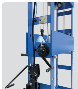
Assise de plateau réglable en hauteur à l'aide d'un palan
