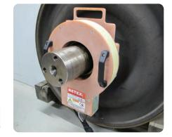
Chauffe de joints labyrinthes pour démontage
