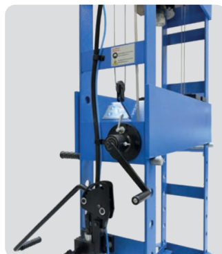
Höhenverstellbarer Tisch mit Hebezug
