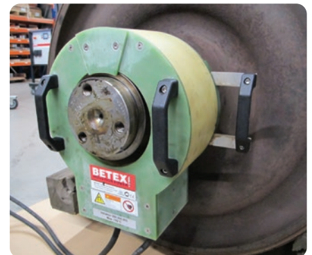
Erwärmung eines Lagerrings zur Demontage
