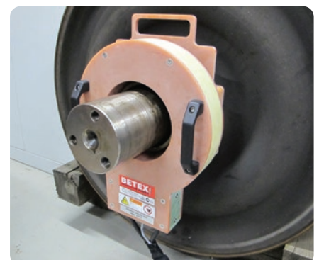
Erwärmung eines Labyrinthrings zur Demontage
