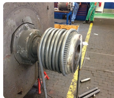
Erwärmung einer Kupplung zur Demontage
