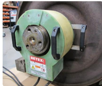
Erwärmung eines Lagerrings zur Demontage
