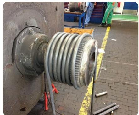
Erwärmung einer Kupplung zur Demontage
