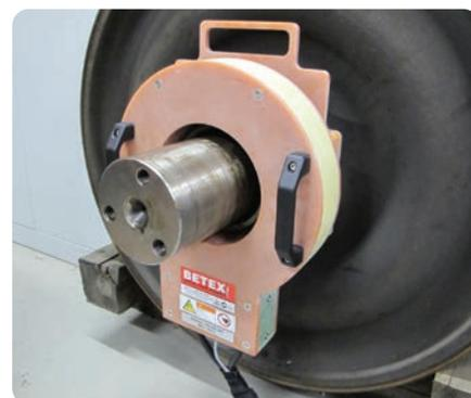
Erwärmung eines Labyrinthrings zur Demontage
